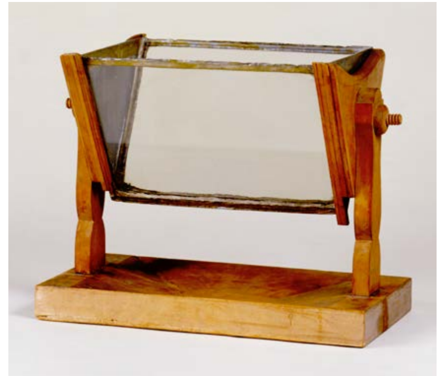
36 Goethes Wasserprisma mit einer Höhe von 30 cm. Aufgrund der Größe erhielt er beeindruckende Spektren! Ein Prisma mit Wasser zu füllen, ist zudem eine ökonomische Variante zu teurem, massivem Glas.
