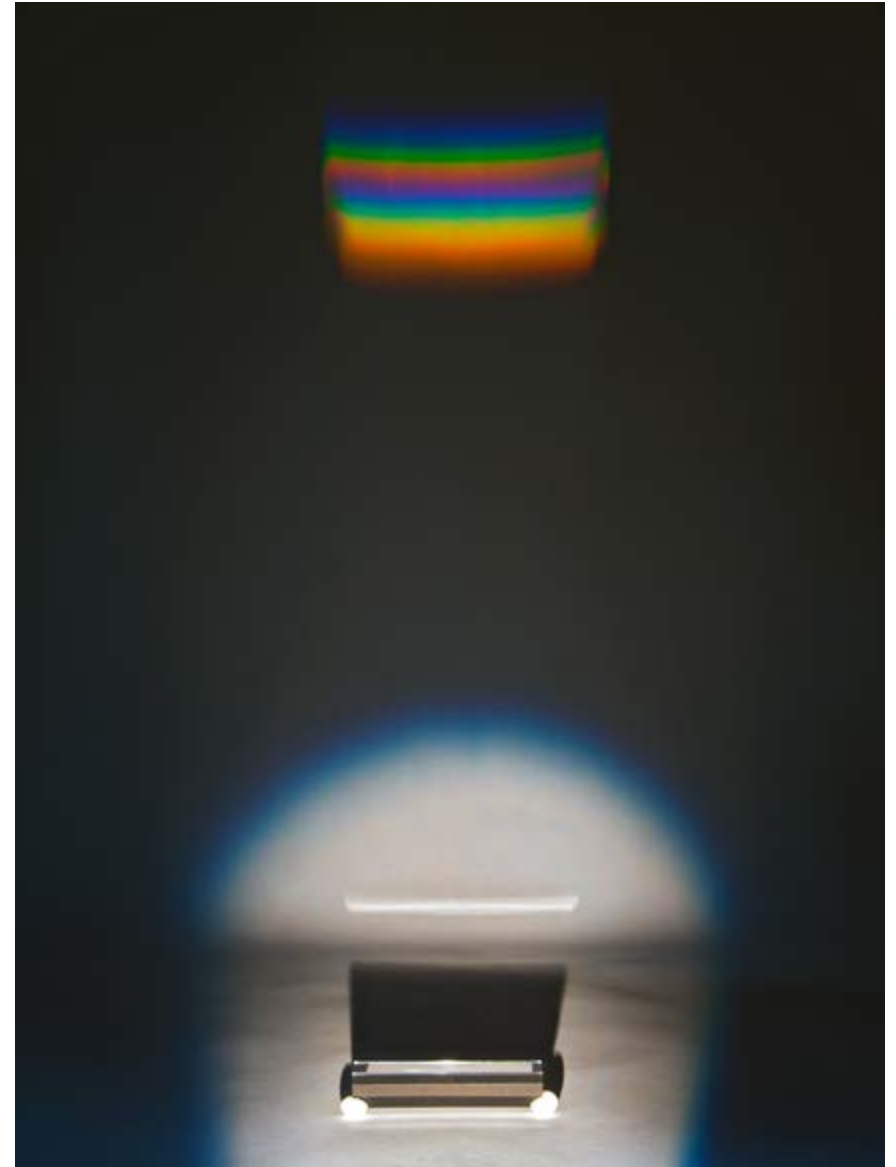
34 Goethes Versuch mit einem Glasprisma, auf das mittig ein schwarzer Papierstreifen aufgeklebt ist. Es entstehen zwei sich überlagernde Spektren mit Purpur (Magenta) im Zentrum: das typische Goethesche Spektrum.
